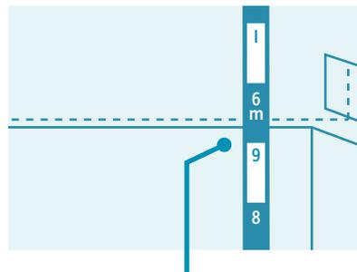
掘削深度が深い等で全景写真が写せない場合には、全体が分かる写真と近景写真の組み合わせで深さが分かるようにしてください。
